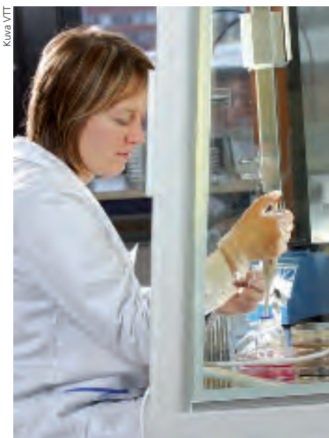
Laminaarivirtauskaapissa kulkeva tasainen, laminaarinen ilmavirtaus varmistaa, ettei haitallisia hiukkasia pääse ympäristöstä ja työntekijästä näytteisiin tai toisiin päin.
